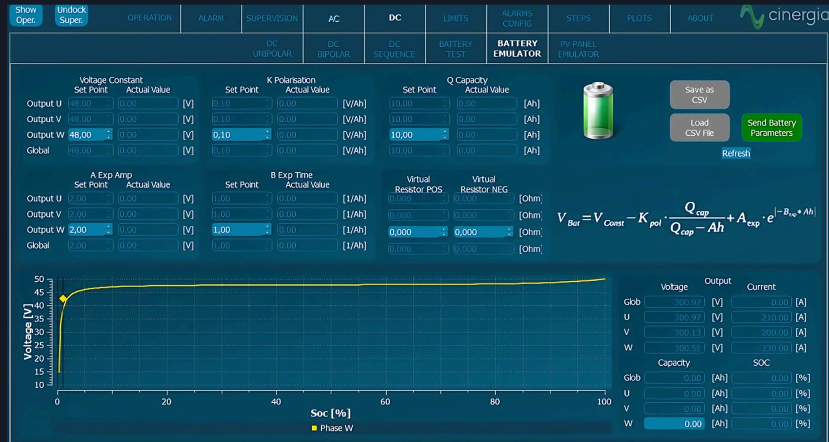
$$V_{Bat} = V_{Const} - K_{pol} \cdot \frac{Q_{cap}}{Q_{cap} - Ah} + A_{exp} \cdot e^{-B_{exp} \cdot Ah}$$
